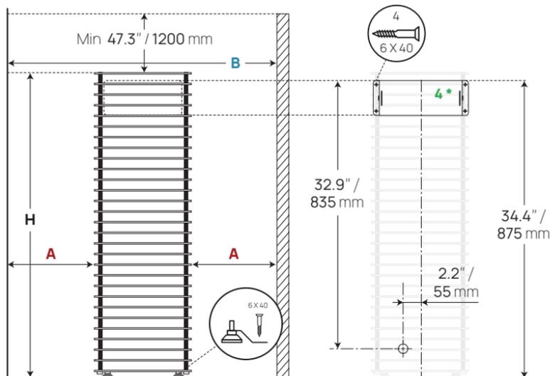
\* On fixe le poêle CLIFF Mini 4 au mur à l'aide d'un support spécial. Pour en savoir plus sur les caractéristiques techniques du poêle CLIFF Mini 4 veuillez voir le tableau ci-dessous.
